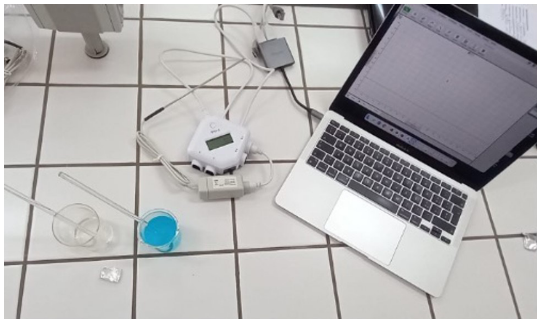
Figura 5. Setup sperimentale della Data Harvest per la misurazione di temperatura: una soluzione di \text{CuSO}_4 , una soluzione di \text{NaCl} e un foglietto di alluminio
