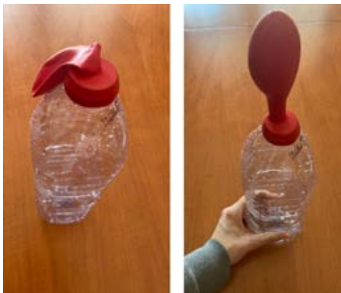
Figura 4. Il palloncino prima e durante l'applicazione di pressione sulla bottiglia
