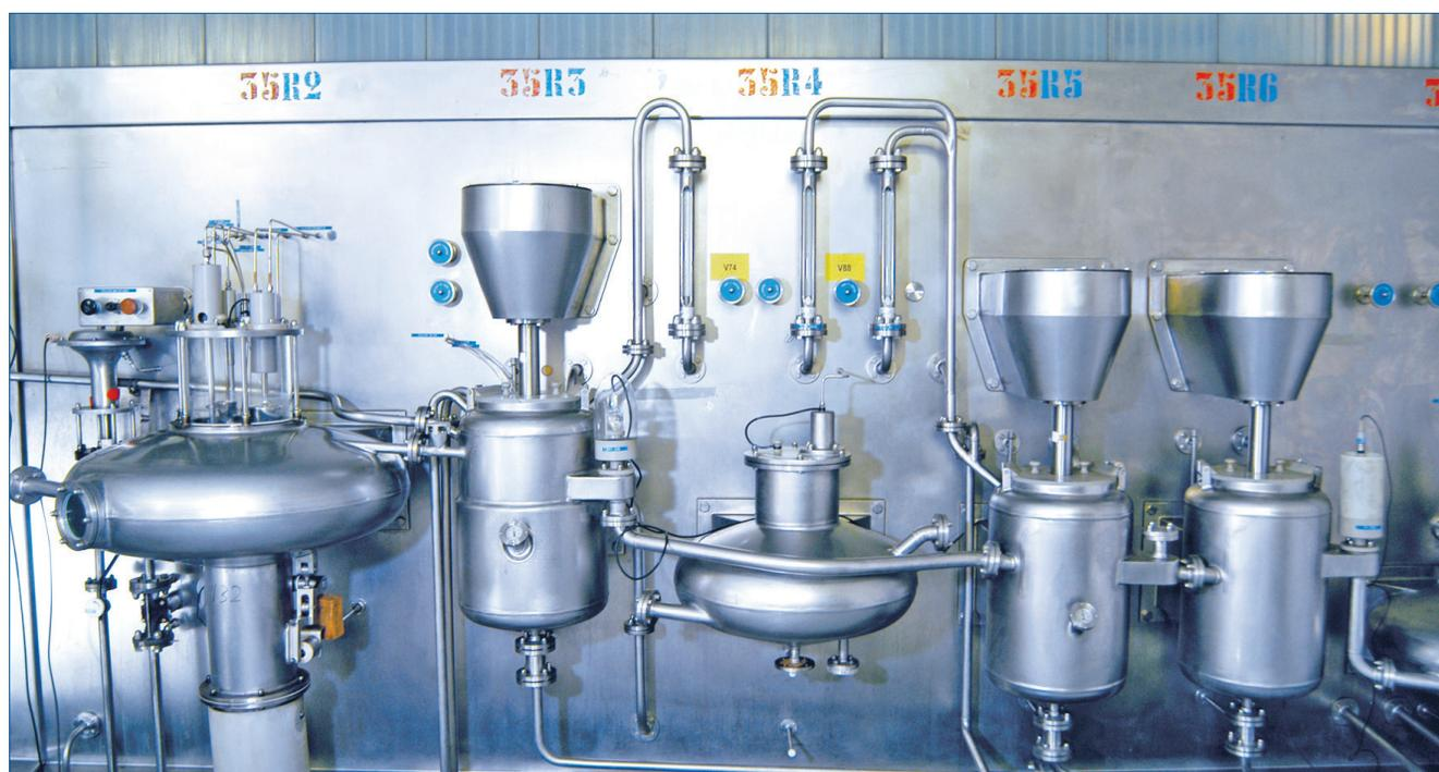
Fig. 1 - Strumentazione Biazzi per la sintesi in flusso di nitroglicerina, ad alto potere esplosivo
