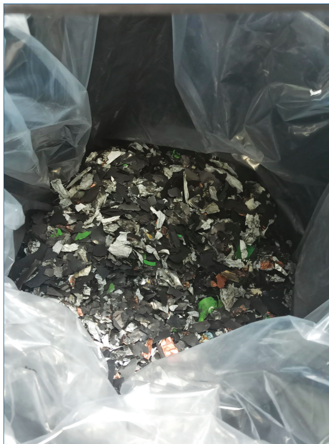
Fig. 1 - Macinato di cella dopo separazione elettrolita
