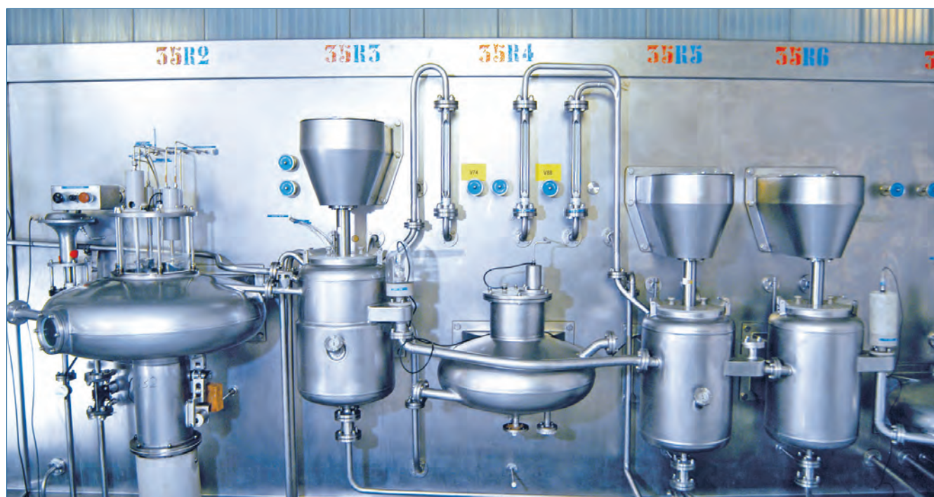
Fig. 1 - Strumentazione Biazzi per la sintesi in flusso di nitroglicerina, ad alto potere esplosivo
