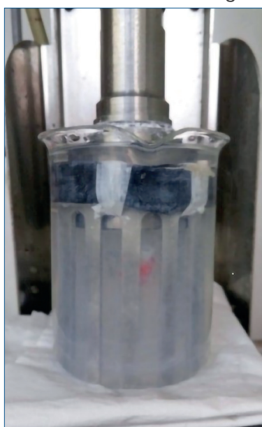
Fig. 3 - L'apparato sonochimico utilizzato per impiantare nanopolveri perovskitiche sui supporti di carburo di silicio
