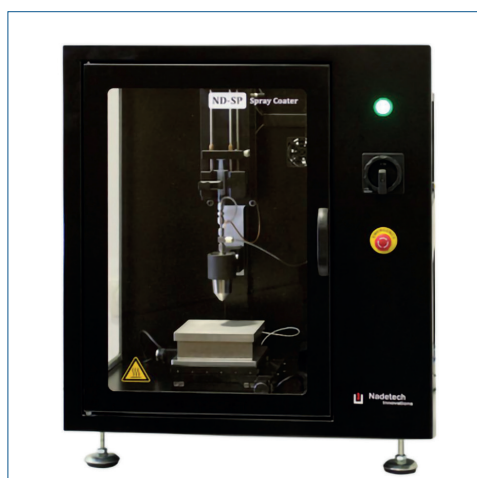
Fig. 4 - Modello dello spray coater ultrasonico in uso nel nostro laboratorio (Nadetch, Spagna)
