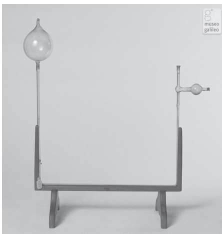
Figura 16. Una delle invenzioni di Benjamin Thompson conte di Rumford: il termoscopio di Rumford, Museo Galileo Firenze.
