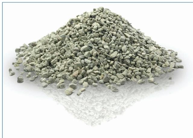
Fig. 5 - Zeolite clinoptilolite granulometria 2-5 mm
