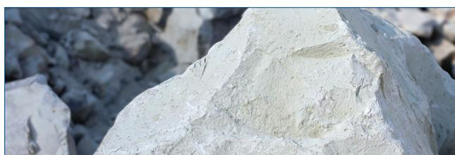
Fig. 1 - Fotografia di zeolite clinoptilolite allo stato naturale
