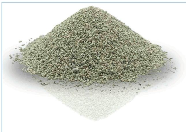
Fig. 4 - Zeolite clinoptilolite granulometria 0,7-2 mm
