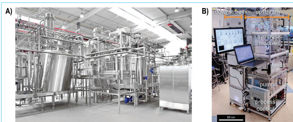
Fig. 1 - Confronto dello spazio impiegato per un impianto batch (A) e un impianto di chimica in flusso (B)
