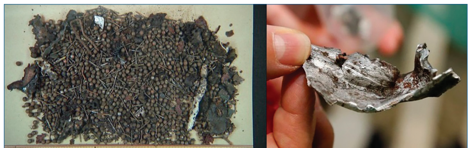
Fig. 2 - Esempi di proiezioni balistiche ( shrapnels ) generatesi a seguito dell'esplosione di un I.E.D.
