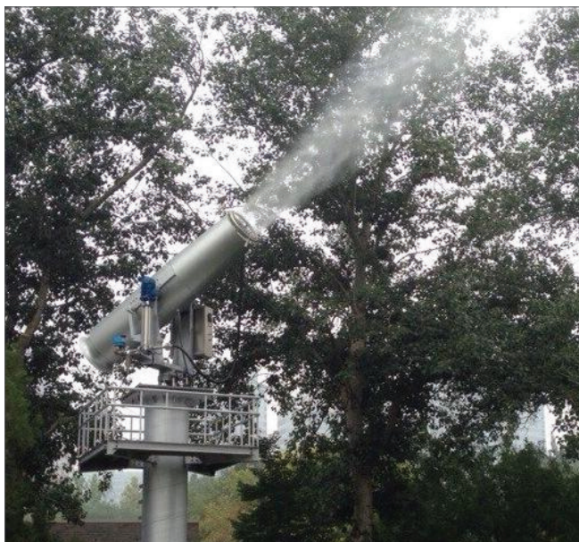
Fig. 8 - Fog-Cannon: cannoncino che nebulizza l'acqua in modo adeguato per umidificare l'aria e abbattere le polveri e gli odori. Posizionato presso l'Ambasciata Italiana a Pechino
