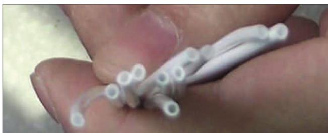
Fig. 3 - Foto illustrative delle membrane utilizzate per il recupero della CO<sub>2</sub> da correnti gassose
