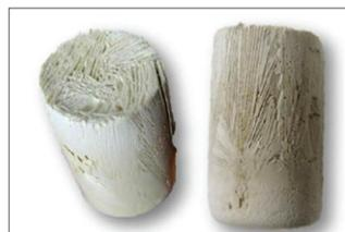
Fig. 3 - Monoliti lamellari ottenuti per *ice-templating*
