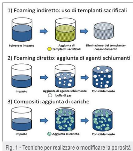
Fig. 1 - Tecniche per realizzare o modificare la porosità
