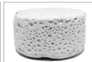
Fig. 4 - Schiuma ottenuta per *foaming* diretto
