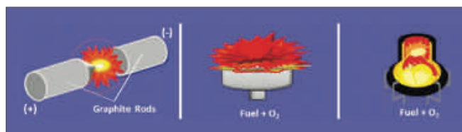
Fig. 1 - Produzione di fullerene. Dalla vaporizzazione sotto vuoto della grafite alla combustione di idrocarburi
