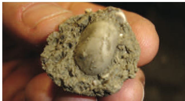
Fig. 3 - Esempio di produzione di un aggregato a partire dal calcestruzzo fresco non gettato (calcestruzzo reso)
