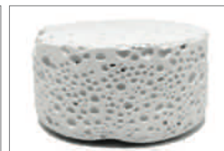
Fig. 4 - Schiuma ottenuta per foaming diretto
