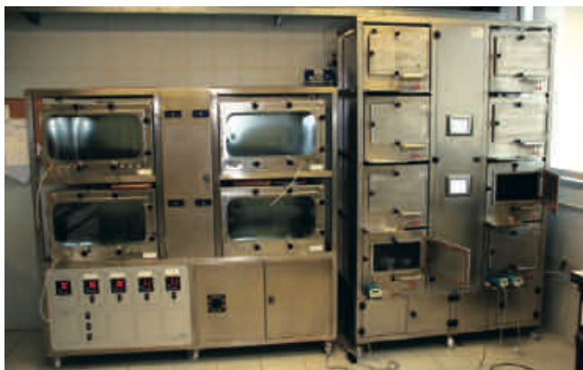
Fig. 2 - Il sistema di marcatura GEM EMICODE e la camera ambientale per la misura delle emissioni di VOC in ambiente "indoor" (Laboratorio R&D Mapei SpA)
