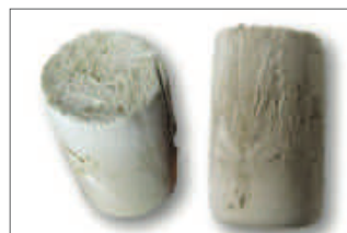
Fig. 3 - Monoliti lamellari ottenuti per ice-templating
