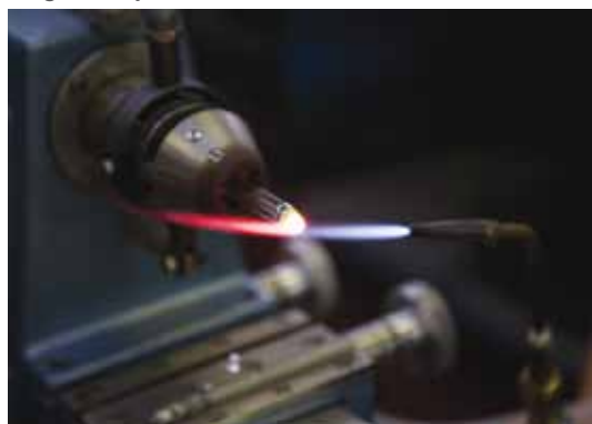
Soffiatura elettrodo pH
